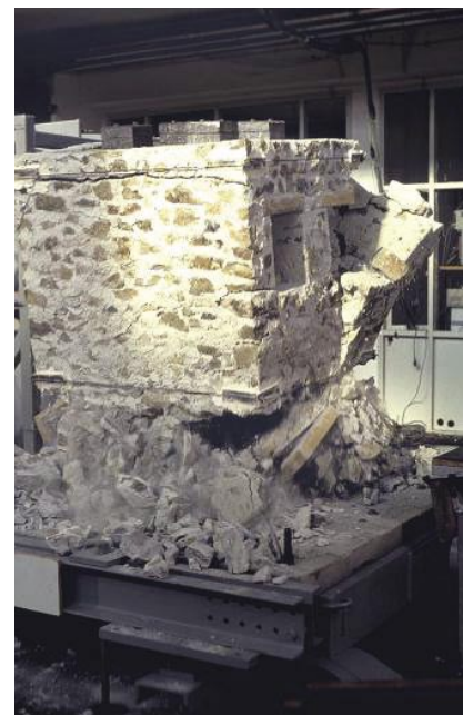
Slika 17 • Porušna faza preiskave modelov kamnitih hiš na potresni mizi: model brez zidnih vezi (levo) in model s povezanim zidovjem (desno) (Fotografiji: M. Tomaževič)
