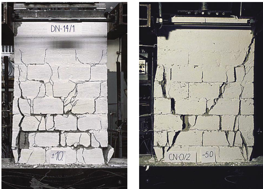
Slika 11 • Vpliv vodoravne armature v naležnih regah na porušni mehanizem: odpornost zidu, armiranega z navpično in vodoravno armaturo, je bila vmes med upogibno in strižno (levo), medtem ko se je zid, armiran samo z navpično armaturo, porušil strižno, kot da sploh ne bi bil armiran (desno). (Fotografiji: M. Tomažević)
