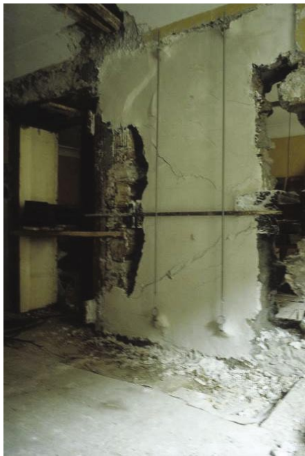
Slika 15 • Ena prvih terenskih preiskav strižne odpornosti kamnitih zidov v Stari Ljubljani (Fotografija: M. Tomaževič)
