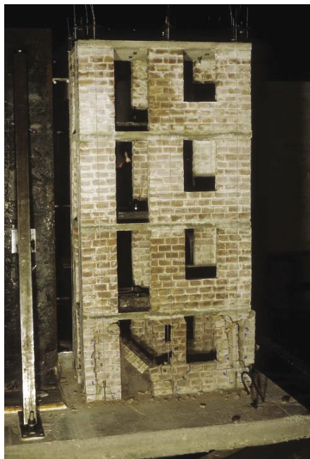
Slika 6 • Model zidane stavbe v merilu 1 : 7 v porušni fazi preiskave na potresni mizi (Fotografija: M. Tomaževič)
