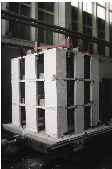
Slika 8 • Upogibni mehanizem obnašanja modela hiše z armiranim zidovjem (Fotografija: M. Tomažević)
