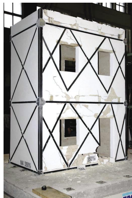
Slika 26 • S karbonskimi lamelami povezan model je prenesel trikrat močnejšo potresno obtežbo kot referenčni, nepovezani model. (Fotografija: M. Tomažević)
