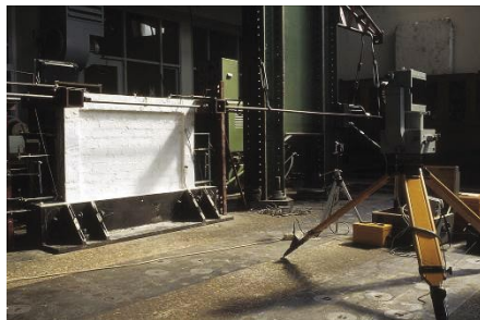
Slika 13 • Fotogrametrične meritve deformacij med preiskavo okvirja s polnilom (Fotografija: M. Tomažević)
