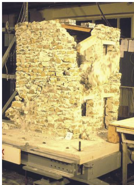
Slika 17 • Porušna faza preiskave modelov kamnitih hiš na potresni mizi: model brez zidnih vezi (levo) in model s povezanim zidovjem (desno) (Fotografiji: M. Tomaževič)
