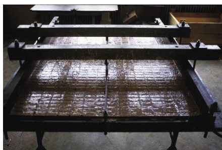
Slika 9 • Izdelava modelnih zidakov z vlivanjem malte v jekleni kalup (Fotografija: M. Tomažević)
