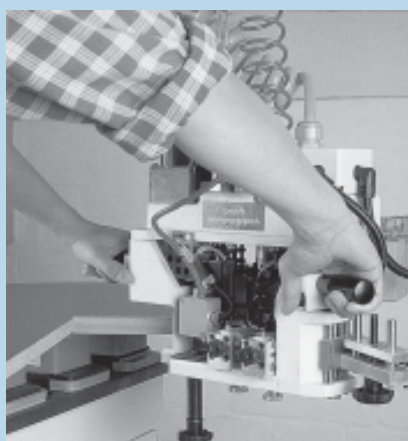
□ Slika 8. Oblepljanje ostro-robih kotov
