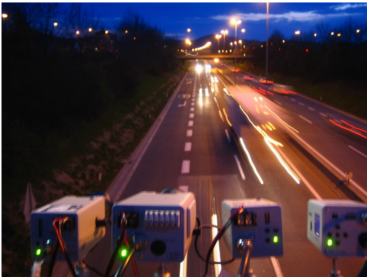
Slika 3-4: Preizkušanje komponent sistema za samodejno identifikacijo vozil na severni ljubljanski obvoznici
