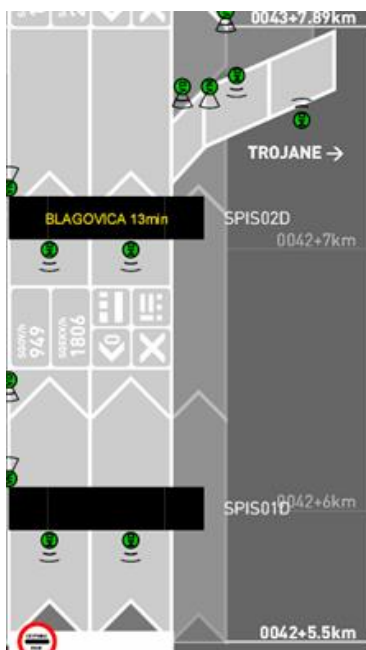
Slika 1-7: Prikaz prometne vsebine o potovalnem času na shematskem vmesniku SCADA Figure 1-7: Variable Message Sign content as shown on SCADA
