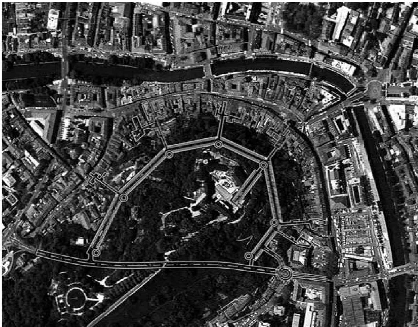
Zasnova podzemnih garajz in spremljajočih objektov v grajskem hribu s konturami trdnih nosilnih peščenjakov
