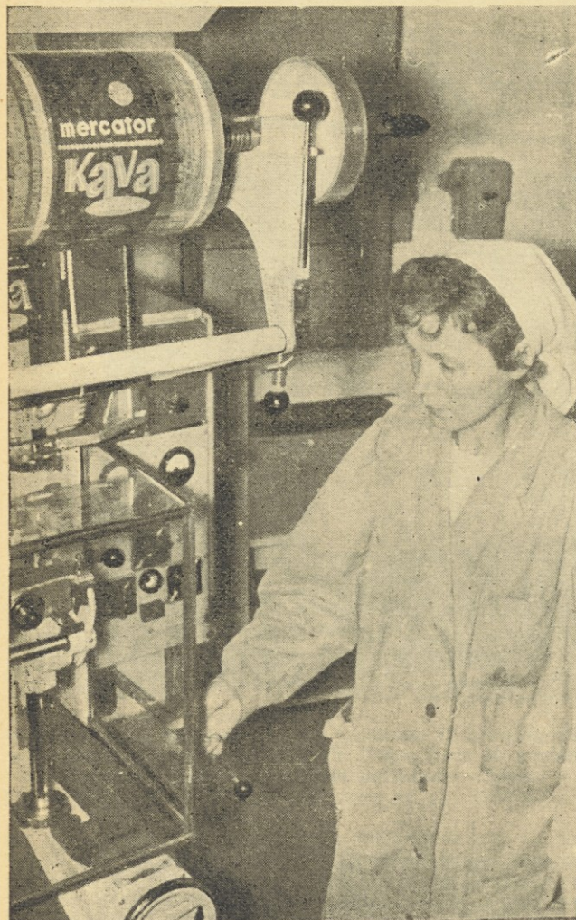
Polnilni avtomat, ki lepi, tehta, polni in zapira vrečke
