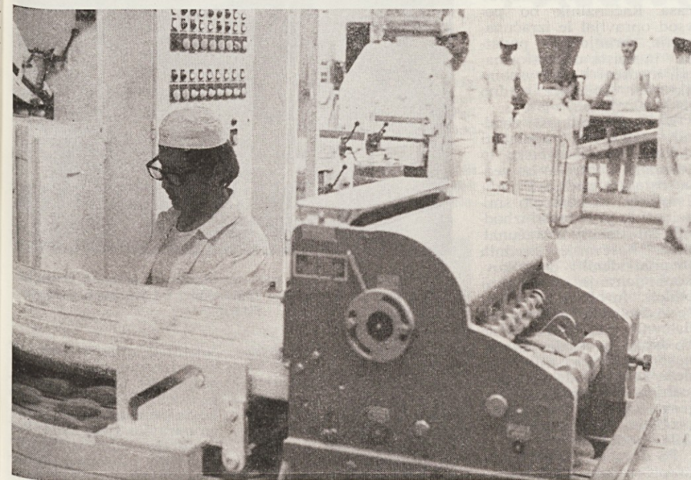
To je oblikovalni stroj za žemlje, levo pa prenosni trak, ki vodi v vzhajalno celico
