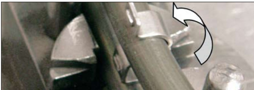
Slika 5. Objemka določa razdaljo med cevema
