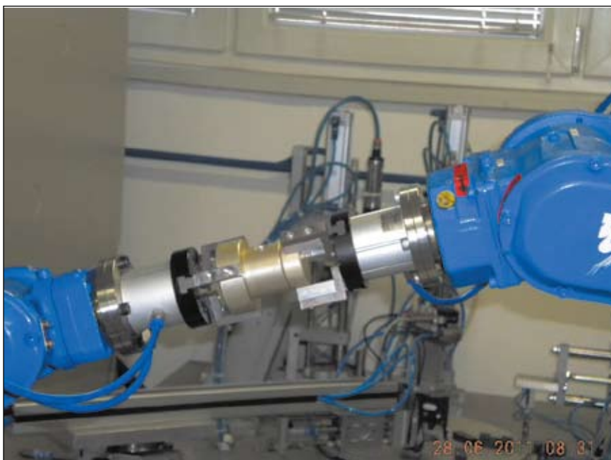
Slika 5. Prijemanje čepa (robot HP20)
