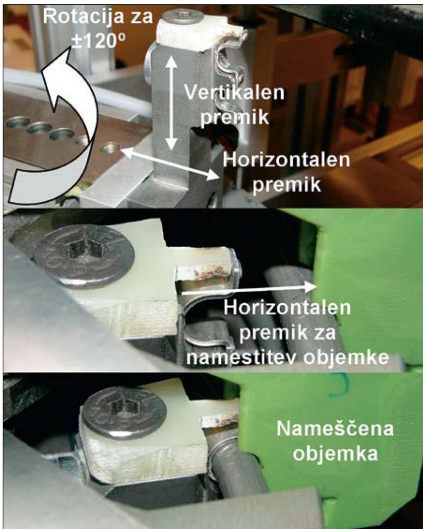
Slika 14. Sistem za nameščanje objemk
