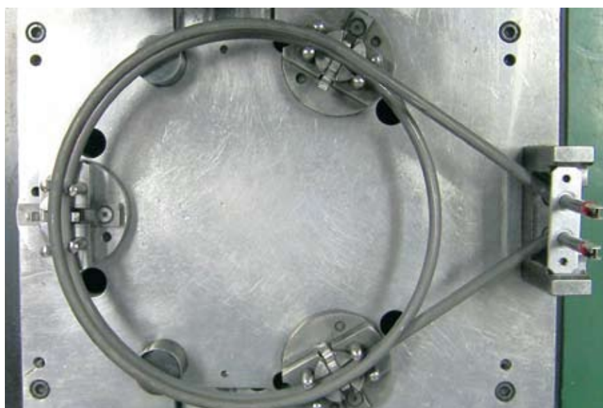
Slika 4. Grelc, vstavljen v ležišča na palet
