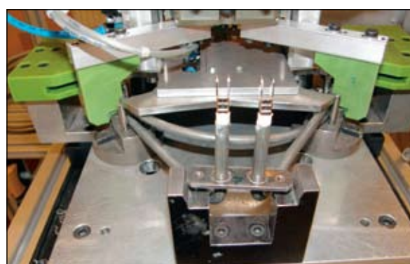
Slika 16. Grelec z objemkami vstavljen v paletu
