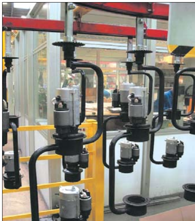
Slika 2. Transportni trak z izdelki pred lakirnico
