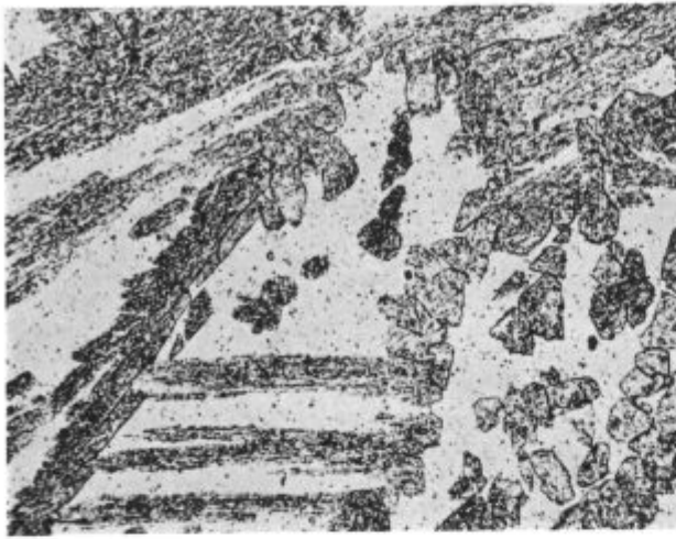
Slika 1 Struktura čistega vara PK 13 v varjenem stanju z vsebnostjo 13% Cr
