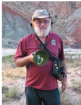
Slika 8: Oprema za snemanje visokotonskih škržadov z usmerjenim mikrofonom in digitalnim snemalnikom, na katerega je nameščen ultrazvočni pretvornik.
