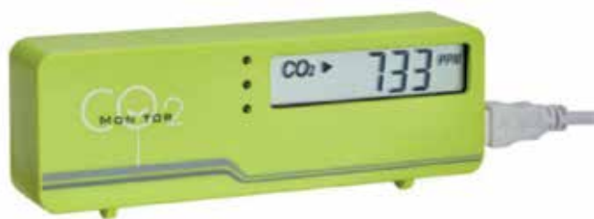
Slika: Namizni merilnik za zasebno rabo v gospodinjstvih z izmeničnim kazanjem koncentracije CO 2 in temperature na zaslonu ter tremi »semaforskimi« signalnimi opozorilnimi lučkami
