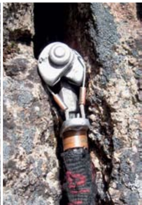
Metulj, ki je nameščen v poč kot zatič, saj se poč zoži v smeri predvidene obremenitve.
