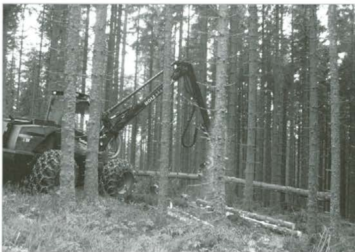
Precizni razrez na označene dolžine
