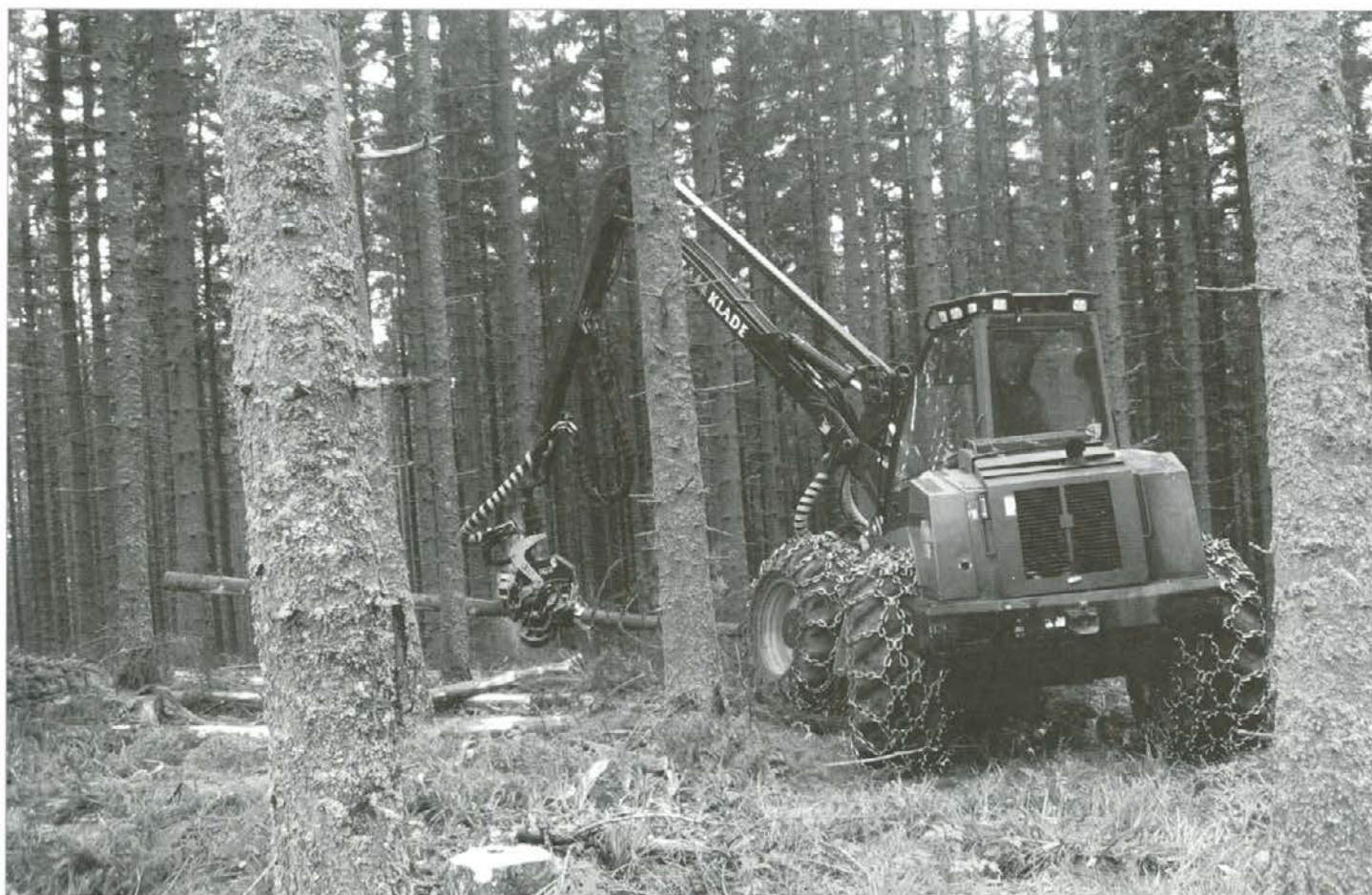
Stroj za sečnjo Harvester poseka v danih razmerah 80 m 3 /dan, sicer pa med 60 in 200 m 3 /dan (odvisno od razmer na terenu, debeline odkaznega drevja, terena, koncentracije odkazila itd.)
