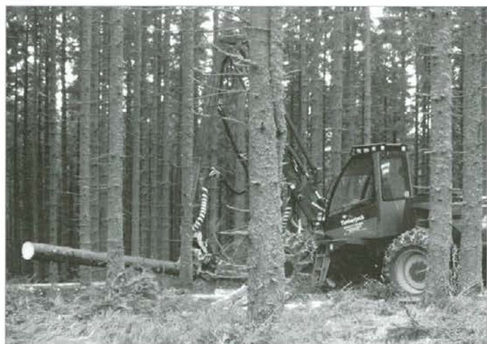
Stroj za sečnjo Harvester poseka v danih razmerah 80 m 3 /dan, sicer pa med 60 in 200 m 3 /dan (odvisno od razmer na terenu, debeline odkaznega drevja, terena, koncentracije odkazila itd.)
