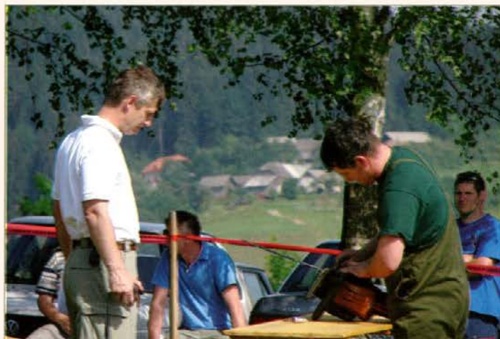
Obračanje letve in napenjanje verige
