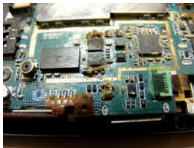
△ Dobro korodirana notranjost telefona zaradi vode.
