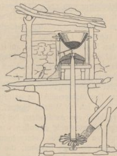
Fig. 40. Schnitt durch eine Turbinenmühle.
