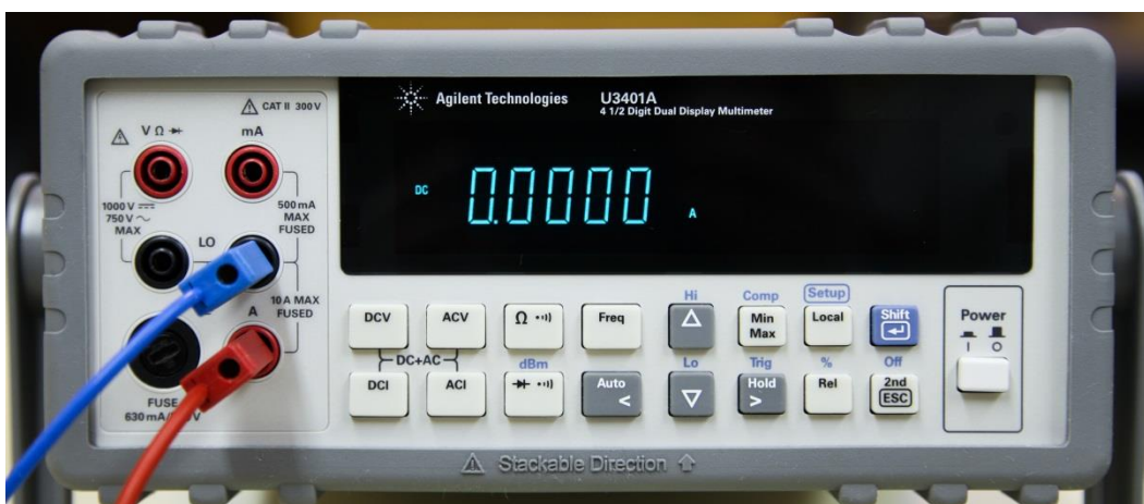
Slika 3: Ampermeter na 5 A merilnem območju
