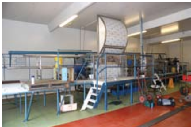
Montaža nove linije za točenje medu z velikim vertikalnim točilom na 180 satov na sredini.
