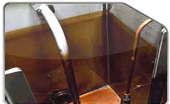
Slika 2 : Lakasti produkti na drsniku krmilnega ventila (levo) [7] in v notranjosti rezervoarja (desno) [8]
