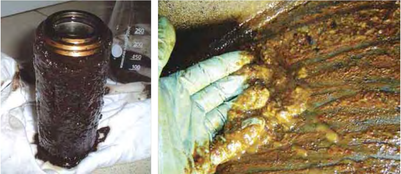
Slika 1 : Popolnoma zamašen – blokiran – filtrski vložek hidravličnega sistema parne turbine –levo (slika last Thomassen Turbines) ter gošča na dnu rezervoarja – desno (slika last Clarus Technologies)
