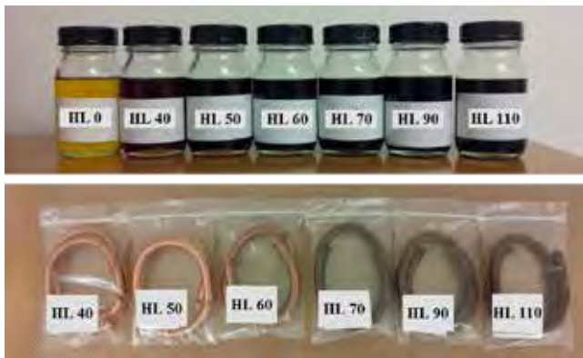
Slika 5 : Vzorci običajnega mineralnega hidravličnega olja po končanem testiranju (zgoraj) in tvorba netopnih lakastih produktov na bakreni žici (spodaj)
