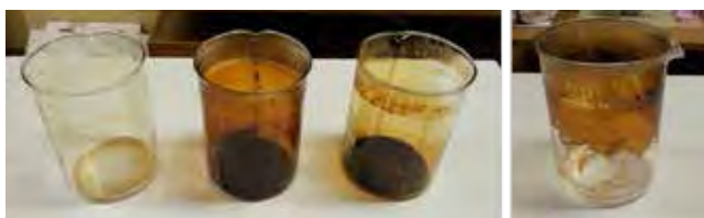
Slika 6 : Tvorjenje netopnih lakastih produktov na stenah čaš in usedlin na dnu
