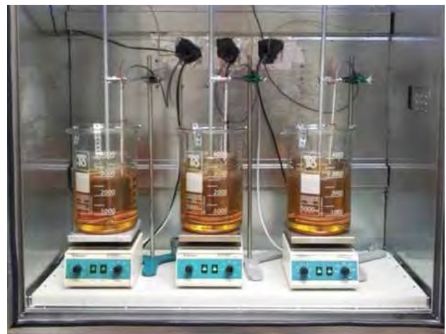
Slika 4: Termični test za pospešeno staranje hidravlične tekočine
