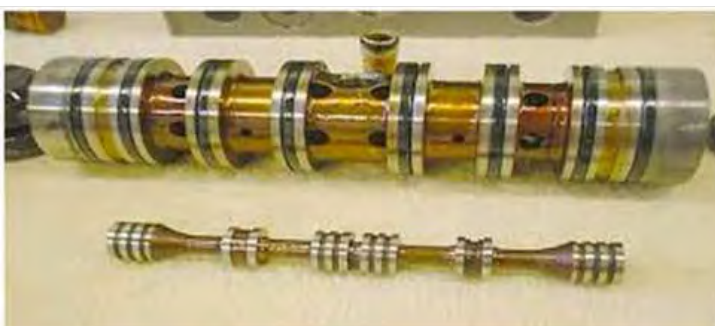
Slika 2 : Lakasti produkti na drsniku krmilnega ventila (levo) [7] in v notranjosti rezervoarja (desno) [8]
