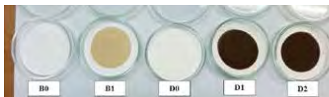
Slika 9 : Stanje filtrov pri analizi MPC po modificirani metodi
