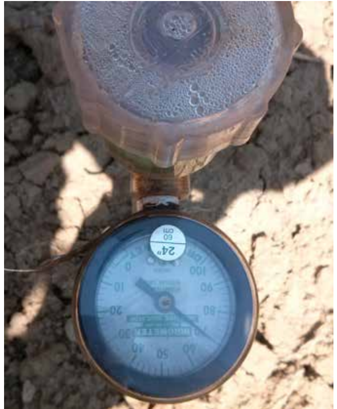
Meritve stanja vode v tleh s tenziometrom (Foto: B. Naglič)
