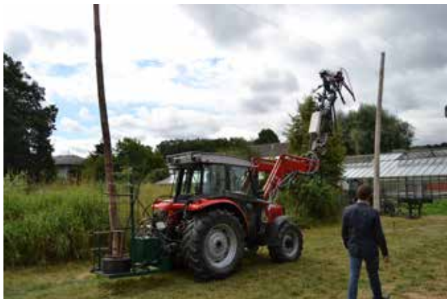
Prikaz prototipa priključka za samodejno napeljavo vodil
