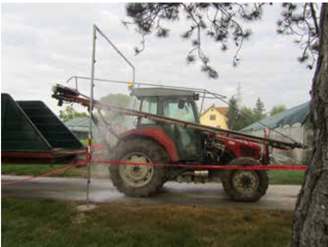
Razkuževalni obroč s šobami, s katerim v celoti razkužimo traktor in orodje (Foto: S. Radišek)
