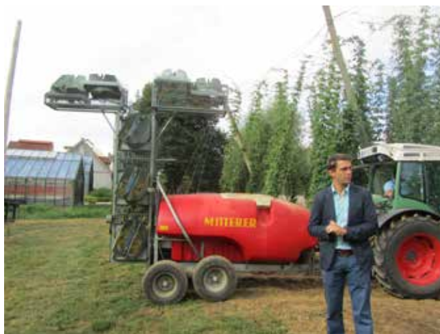
Razlaga ob prototipu pršilnika (v razvoju) za etažni nanos FFS
