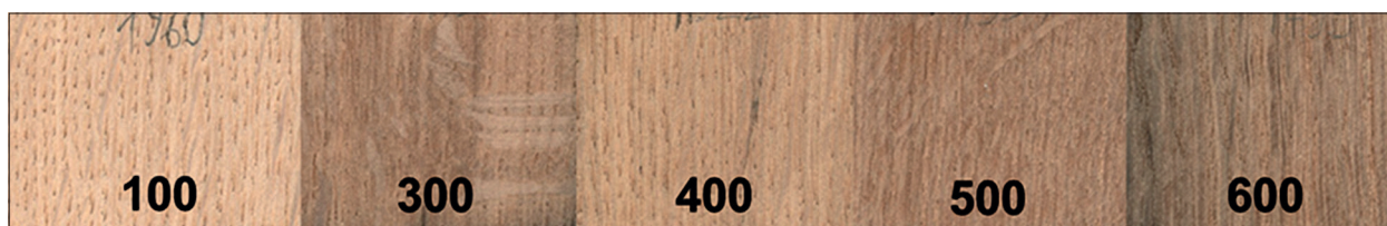
Slika 2. Videz tipičnih hrastovih preizkušancev od najmlajše do najstarejše starostne skupine (100–600 let) (po Straže et al., 2018).
