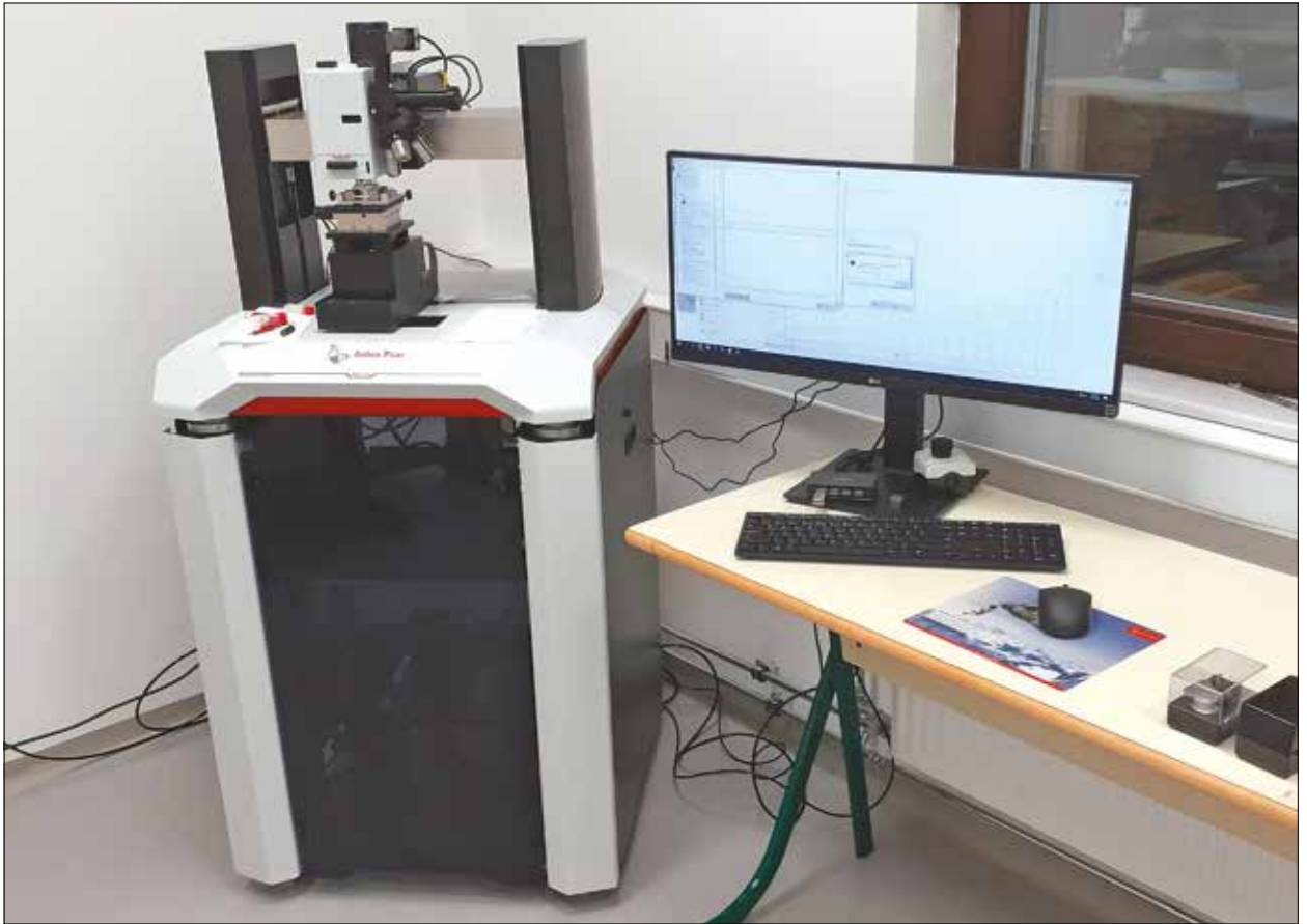
Slika 1. Mikroindenter MCT3 v novem laboratoriju skupine za površinsko obdelavo (Foto: J. Žigon).
