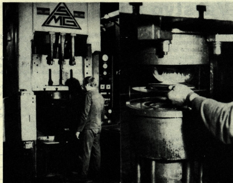
Dne 19. 9. 1985 je prišlo do težje nesreče v vlačilnici (obrat surovinske predelave) TOZD Posoda. Delavec J. B. je z golo roko odstranjeval raztrgano pločevino iz orodja stiskalnice. Posledica takšnega načina dela je bila močna poškodba – stisnina med palcem in kazalcem leve roke. Vzrok nesreče je neupoštevanje navodil za varno delo na stiskalnicah.
