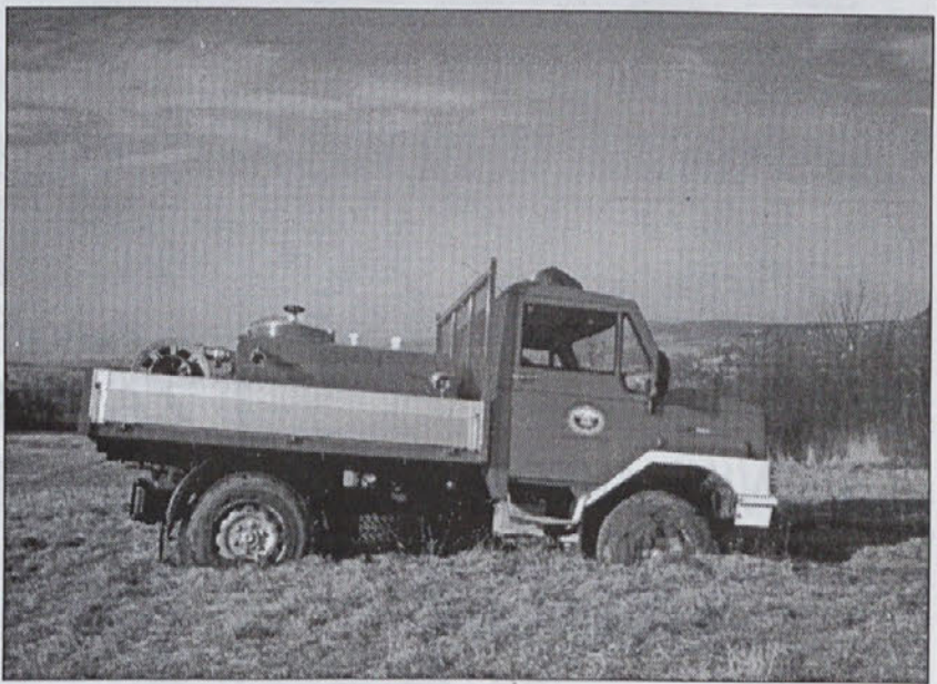
Bistriški gasilci uporabljajo za gašenje požarov na težko dostopnem terenu vozilo znamke Bremach, ki ima cisterno s 1000 litri vode ter visokotlačno in nizkotlačno črpalko.
