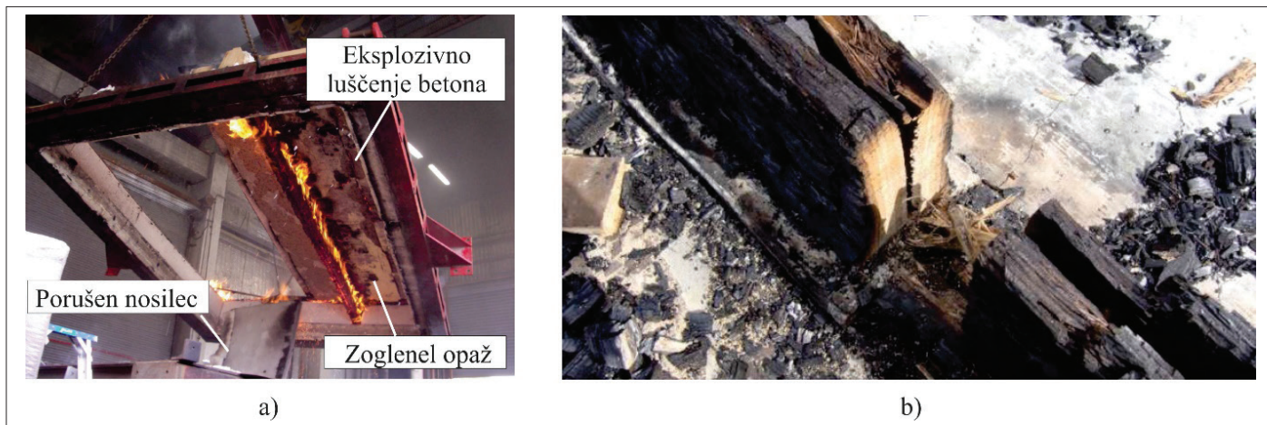
Slika 5 • Kompozitni nosilec z vzporednima lesenima nosilcema (O'Neill, 2009) a) med testom, kjer se je eden od dveh hkrati testiranih preizkušancev že porušil, in b) po testu, z opaznim razmikom med vzporednima lesenima nosilcema zaradi odpovedi vodoravnih jeklenih vijakov (nosilec je tu položen z betonsko ploščo navzdol).
