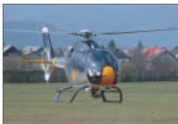
Slika 4: Sistem za pregled naprav iz zraka z vgrajeno kamero DayCor II na helikopterju.
