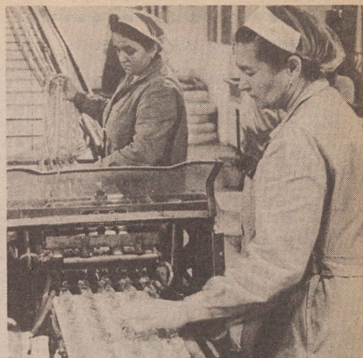
Tako pri Vedrogu polnijo šampone. Dolga polivinilasta kača se spreminja v stroju v neskončni trak iz samih šamponov. Treba jih je le še razrezati in že so pripravljeni za pot med kupce. - Foto M. Dimitrič
