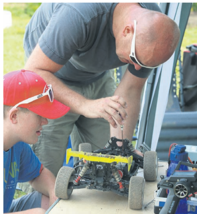
Gre za »off road« radijsko vodene modele avtomobilčkov, s katerimi tekmujejo na grbinah. So v razmerju 1:8, poganja jih elektromotor. Dosežejo hitrosti do 65 kilometrov na uro.
