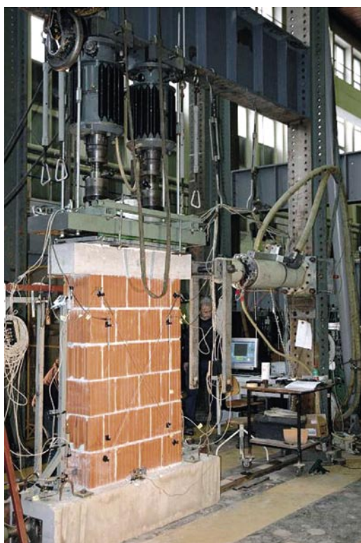
Slika 5 • Zasnova preiskav – a) zidovi tipa B; b) zidovi tipa A
