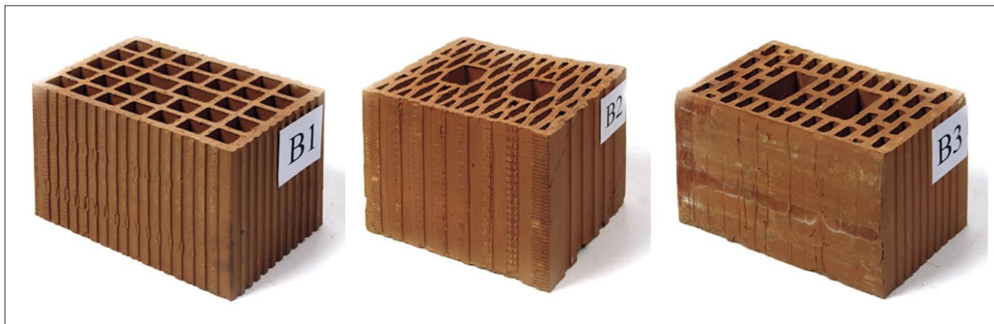
Slika 2 • Opečni votlaki, uporabljeni za zidanje preizkusnih zidov serije B: h/l = 1,5 Votlaki tipa B1, B2 in B3
