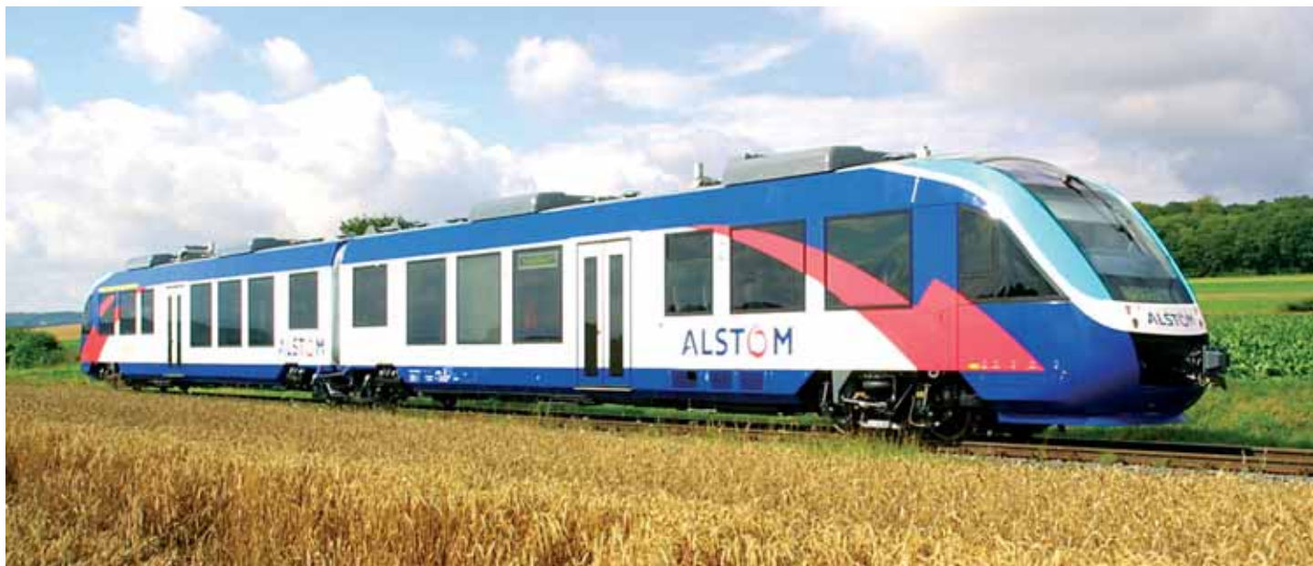
Dvodelni dizel motornik LINT41, ki jih je Alstom od leta 2000 izdelal že prek 300 kosov.
