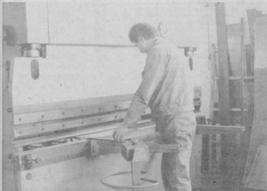
Slavko Hlastec, delavec Kongrada, pri stroju za krivljenje pločevine.
