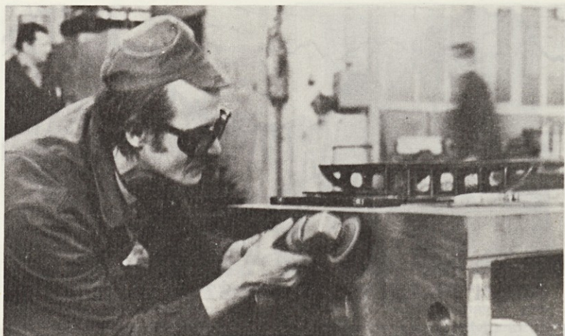
Tovariš Jernej Mlinar z veliko natančnostjo pripravlja oblogo in vodilnikov obroč pred sestavo v celoto.
