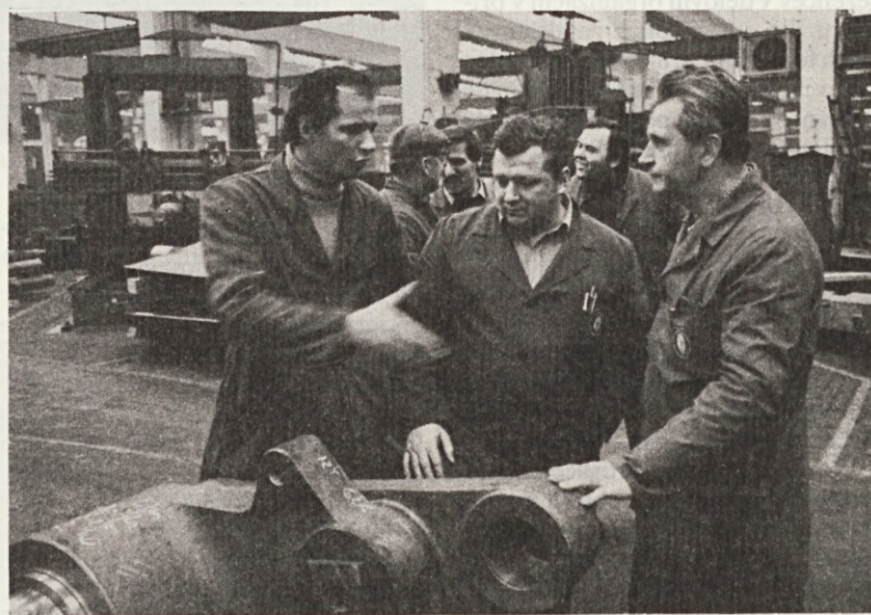
Zadnji »bojni« posvet med tozdoma Obdelavo in Montažo za montažo ročic na vodilne lopate za HE Haditho na posebni pripravi, kjer bo moč narediti izvrtine za zatiče brez poizkusne montaže (Foto: E. L.)
