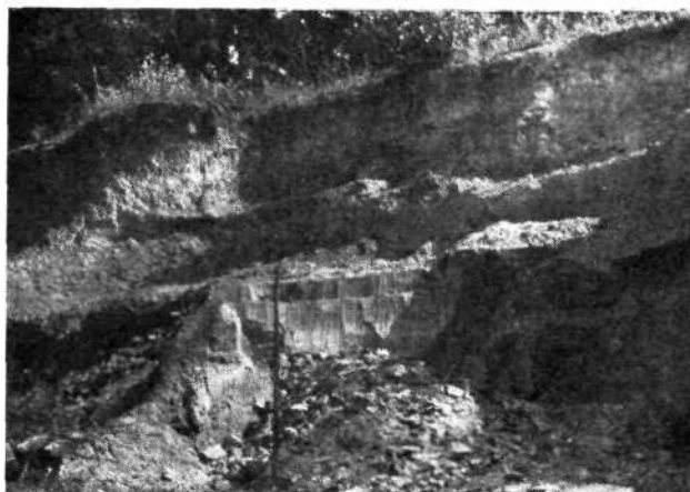
Vertikalni prerez glin in ilovic v kopu Jenkove opekarne. Spodaj je modra jezerska glina, nad njo pečene potočne ilovice
