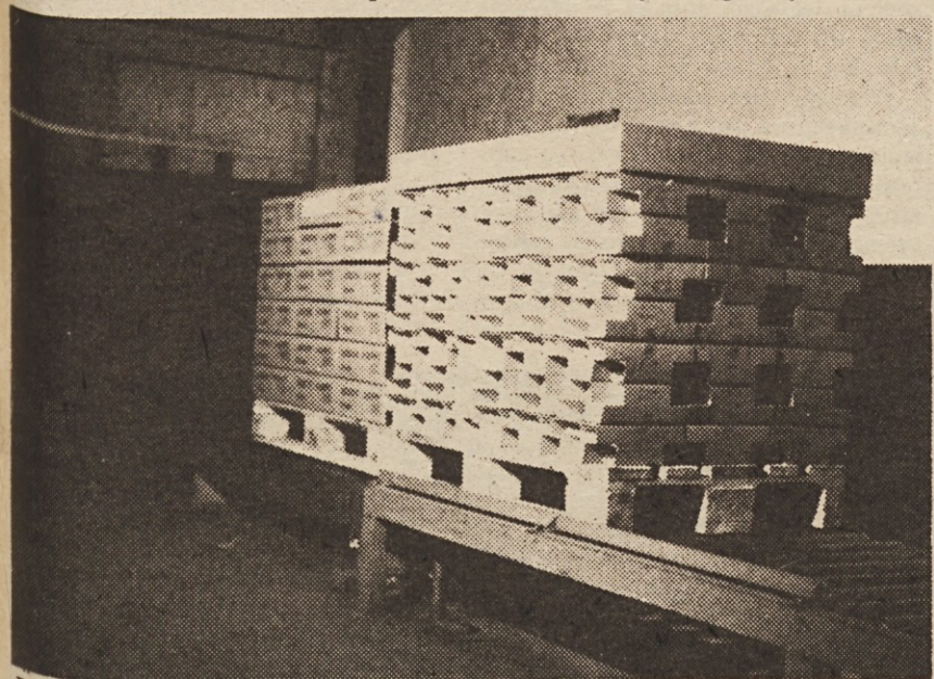
Paletizirana pošiljka se pomika proti peči, kjer bo obdana s skrčljivo folijo.
