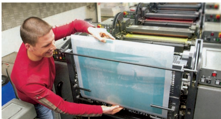
Slika 1. Agfine ofsetne plošče temeljijo na novem kopirnem sloju za termično fiksiranje. Pri tem laser s sevanjem 830 nm povzroči stapljanje emulzije in aluminijaste podlage. Potrebna sta odstranitev neosvetljenih površin kopirnega sloja in gumiranje prostih površin.
