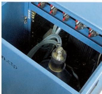
Slika 2. Naprava za čiščenje razvijalca pri digitalnem kopiranju sedaj obratuje brez filtrov. Čisti centrifugalna sila ...
