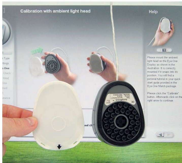
Merjenje barvne temperature svetlobe v prostoru. Kalibrator preveri tudi, če se razmere ujemajo s standardom SIST ISO 3664:2002 Pogoji za vizualno opazovanje - Grafična tehnologija in fotografija.
