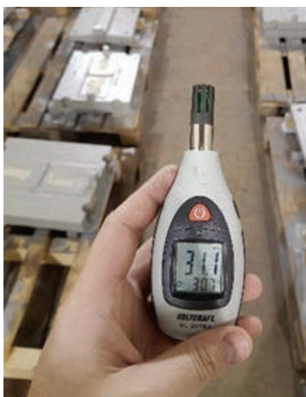
Slika 17 • Kontrola temperature in vlažnosti v barvalni komori.
