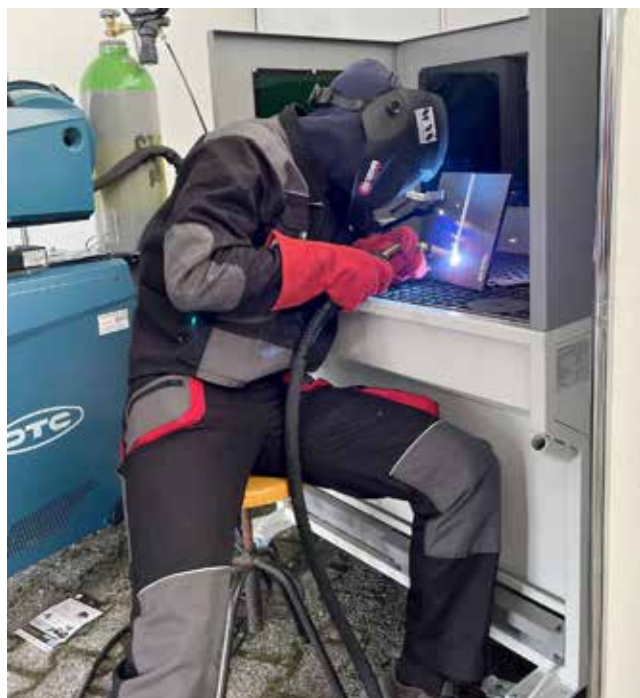
Slika 3 : Varilec pri varjenju navpičnega vara po postopku MAG
