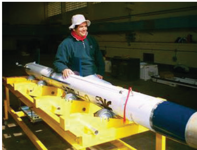
Druga stopnja sondažne rakete PBX 100/10
