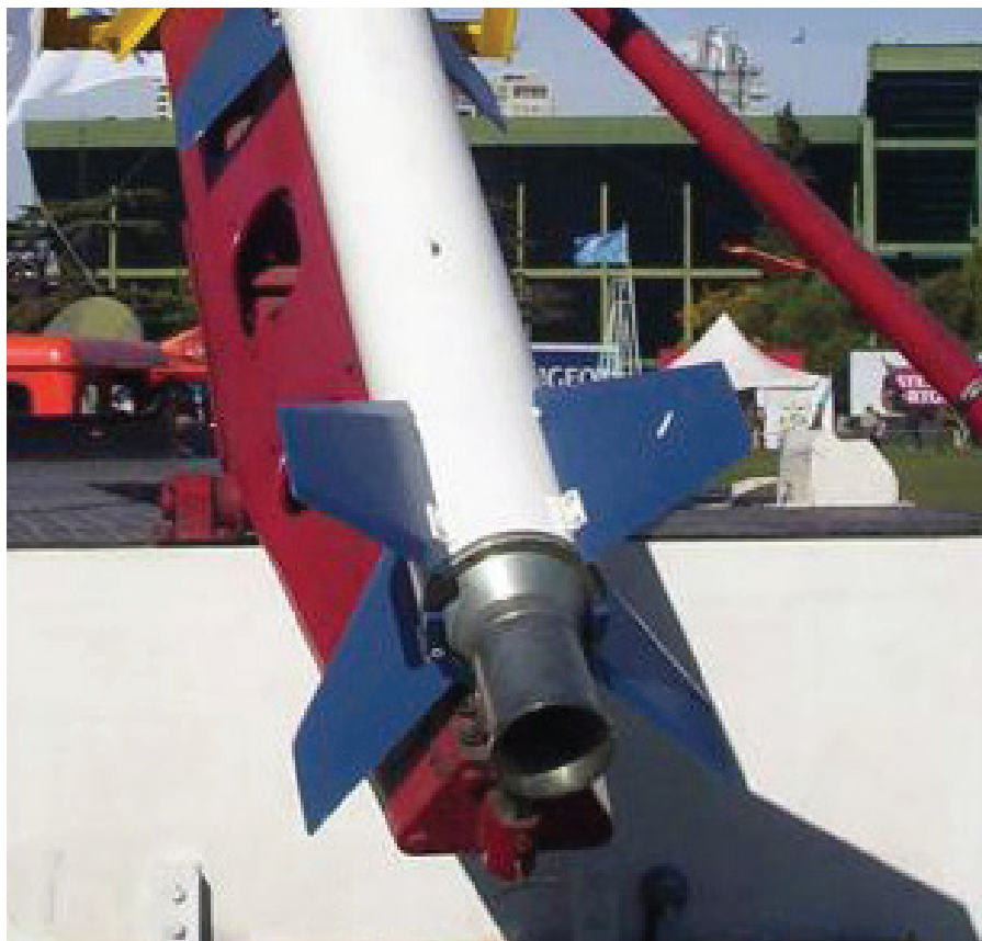
Pogled na šobo motorja prve stopnje rakete PBX 100/10
