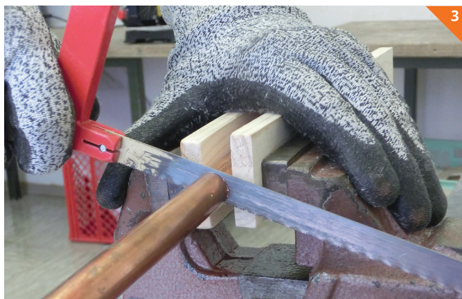
Cev zaščitimo, vpneemo v primež in na označenih mestih odžagamo
