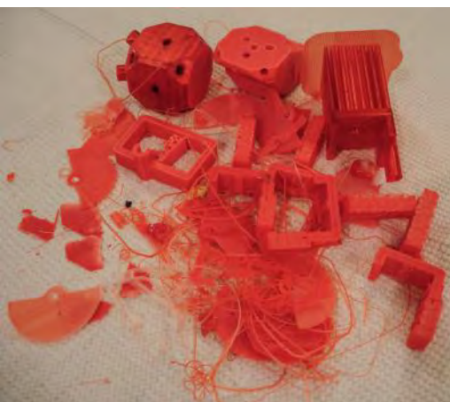
Slika 2. Uspešno in neuspešno natisnjeni deli pripomočka za umerjanje. Pozna se, da ima Hullovo izum za seboj nekaj stoletij izpopolnjevanja manj kakor Gutenbergov. Foto: Matija Perne
