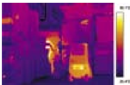
Slika 13. Lociranje latentnega požara v tovarni izolacijskega materiala
