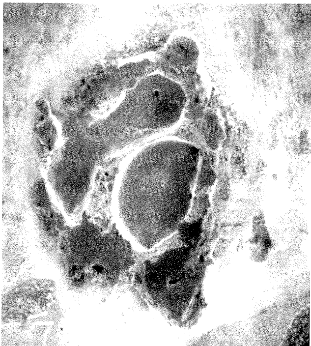
Slika 5: Mikrosvar na kontaktnem mestu po vklopu toka, stanje po razmaknitvi kontaktnih površin, SEM – dolžina markerja 100 \mu\text{m}
