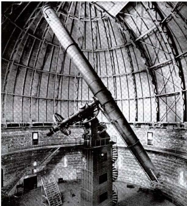
Slika 3. Clarki so izdelovali objektivne za največje refraktorje, ki so jih tudi montirali. Največji med njimi so na observatorijih: Lowell (premer objektivna 60 cm), Washington (66 cm), Pulkovo (76 cm), Lick (91 cm) in Yerkes (102 cm; na sliki). Yerkesov objektiv je do danes ostal največji na svetu.
