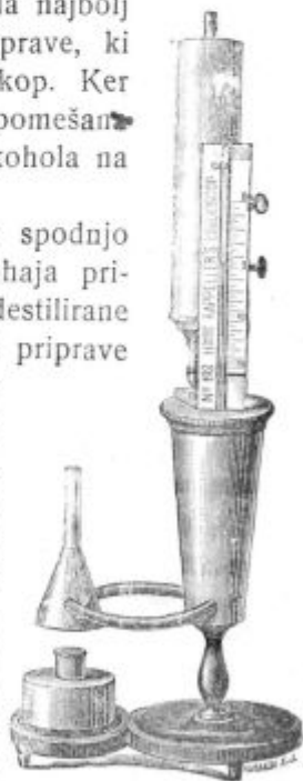
Pod. 20. Ebullioskop, priprava za določevanje alkohola v vinu.
