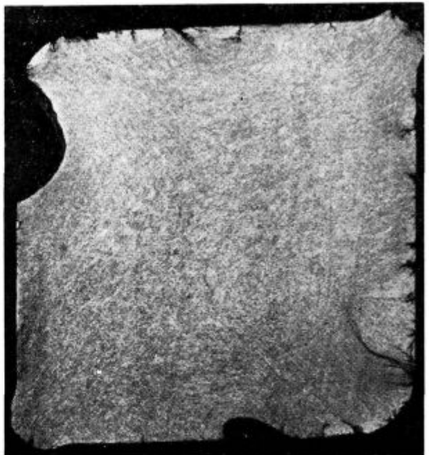
Slika 1 Raztrganine na površini gredice Fig. 1 Pulls on the surface of a billet
