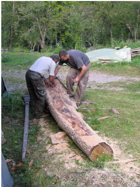
Slika 203: Posebnost domačije Zajskih je tudi obnovljena naprava – koloter za drobljenje sadja pred skednjem. Jurinav Drago in Roman pri obdelavi ločno zakrivljenega hrastovega korita, v katerem se je s kamnitim kolesom na dolgi leseni osi trlo največ jabolka in hruške pred prešanjem v mošt.
