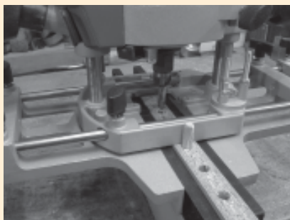
□ Slika 2. Izdelava moznične vezi z rezkalnikom - čelno vrtanje z dvema prislonoma in moznikom kot "omejilec"
