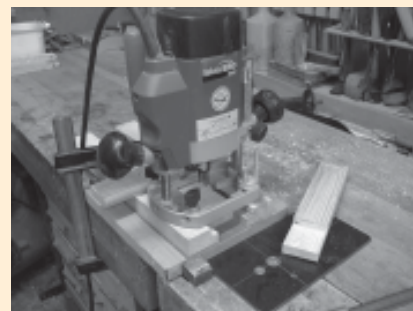
□ Slika 1. Izdelava kotne vezi z rezkalnikom v šablono
