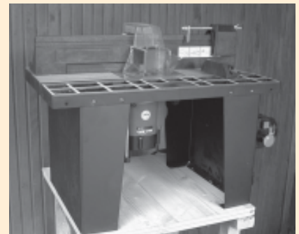
□ Slika 6. Primerno velika delovna miza za vpetje rezkalnika z domišljenimi vodili, stikalom in ustrezno zaščito
