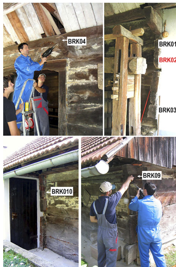
Slika 2. Berkovičev hram z mesti odvzema dendrokronoloških vzorcev. Bruno BRK02 je imelo največ branik beljave (Foto: K. Čufar 21. 9. 2004). Figure 2. Berkovič wine cellar with locations of beams selected for dendrochronological dating. The beam BRK02 contained the greatest number of sapwood rings (Photo: K. Čufar 21 st Sep. 2004).
