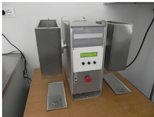
Slika 3. Naprava lastne izdelave za analizo mehanske obstojnosti pelet (foto: N. Krajnc)
