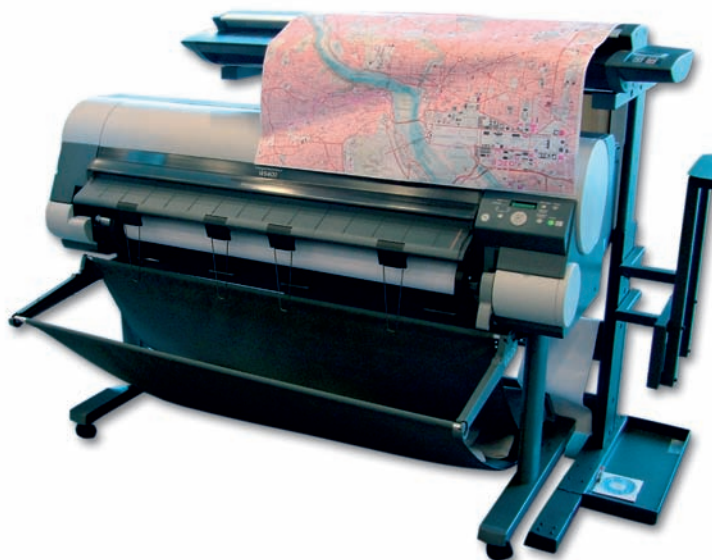
Širokoformatni tiskalnik Canon W8400 je dovolj precizen tudi za tiskanje načrtov in zemljevidov.
