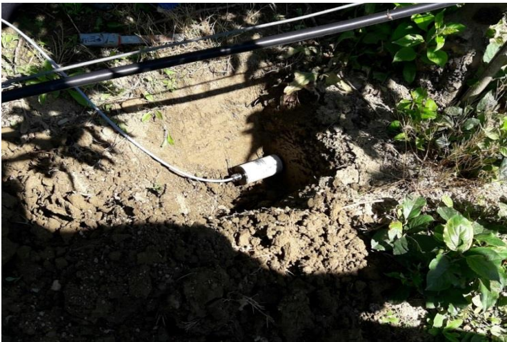
Slika 71: TDR sonda vstavljena v nasadu jablan v Sadjarskem centru Gačnik.
