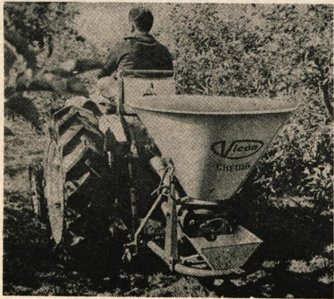
Deponator za dognojevanje pod zemljo za vinograde in sadovnjake, priključek na trosilec s kapaciteto 400 l.
