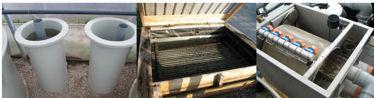
Slika 11: Različne naprave za odstranjevanje trdnih snovi: lovilnik blata (a); filter za grobo obdelavo (b); rotacijski bobnasti filter v ZHAW (c) (foto: U. Strniša)
