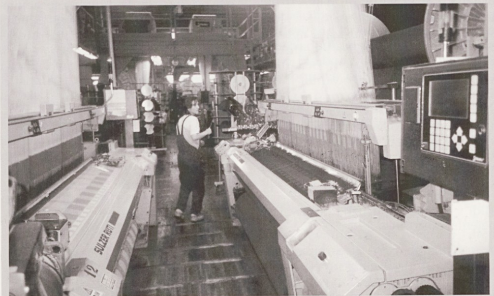
Brez dobrih »starih« Sulzerjev pa v naši tkalnici ne gre; na njem se tke najzahtevnejši program (na primer 7-vezni frotir)
