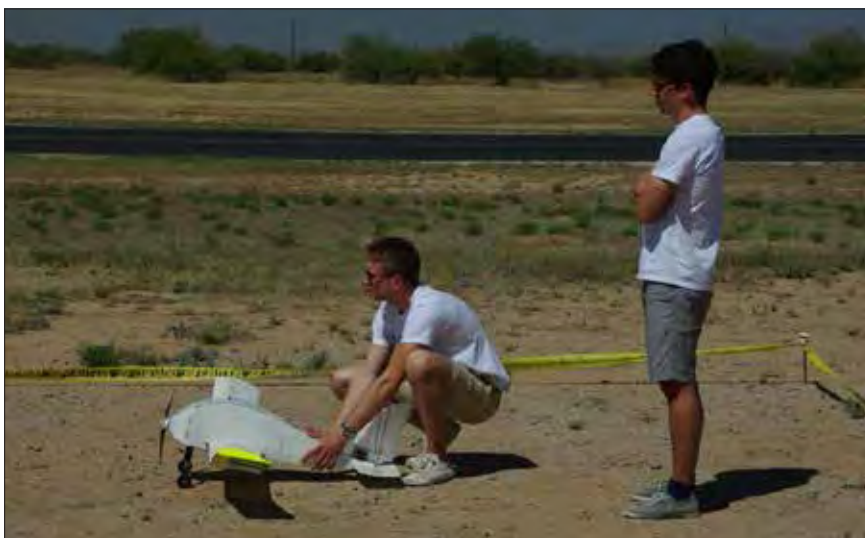
Preizkus motorja in delovanja krmilnih površin ter preizkus delovanja varnostnega izklopa letala
